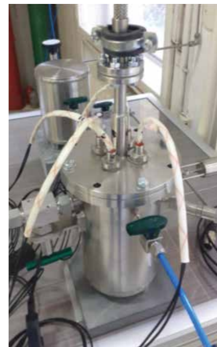
Tank za skladištenje vodonika u obliku hidrida
